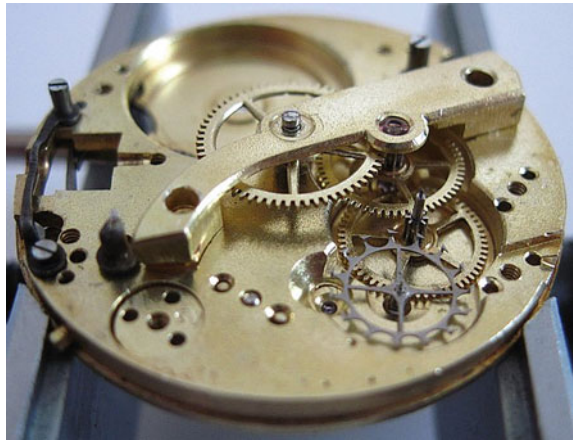
Fig. 2.28 Zylinderwerk 2 using cylinder escapement
